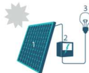
1. Zonnepaneel | 2. Omvormer | 3. Elektrische toestellen
